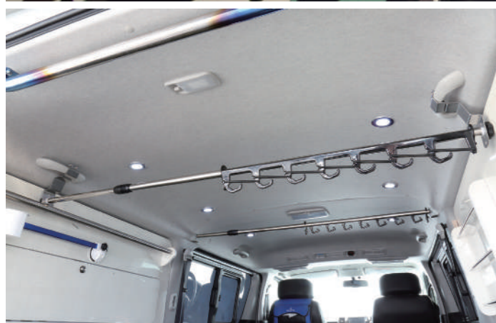
「釣りエース」の大きな特徴のひとつであるロッドホルダーは水に強いステンレス製。最大7本が掛けられます。
