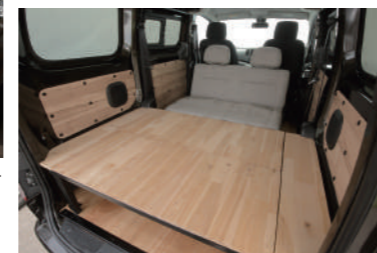
展開方法がわかりやすい FWS シートを採用。2人掛けの前向き&後ろ向きポジション、フルフラットモードへの展開が容易です。
