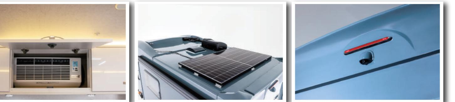
室内の吊り下げ戸棚の中に収まる車載用 DC クーラー。直流電気で稼働するので、電気の変換口スもなく、効率よく室内を冷やす。
