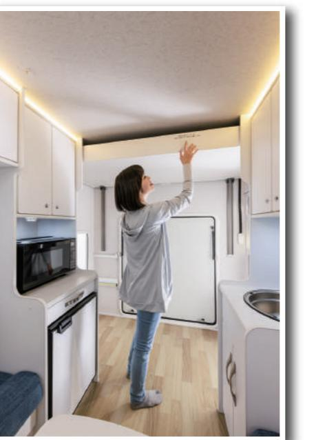
リアに電動フルダウン式 2段ベッドを装備している。1段目のベッドマットを外して、2段目のベッドを上に移動すれば、リアエリアが広々としたラゲッジスペースになる。
