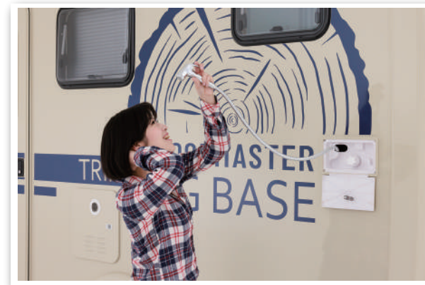
アウトドアシャワーを設置。外用のシャワーヘッドは外側のボックスに収納されている。マリンスポーツの時などがあると便利だ。
