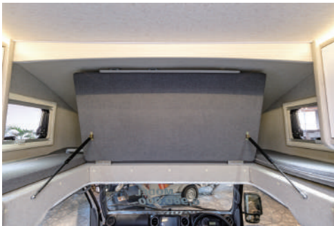
バンクベッドを跳ね上げた状態。ダンパー付きなので、軽く持ち上げるだけで開きます。
