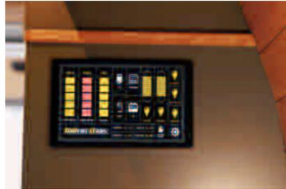
大型キャンピングカー同様のコントロールパネルを装備。設備のオンオフも操作できます。
