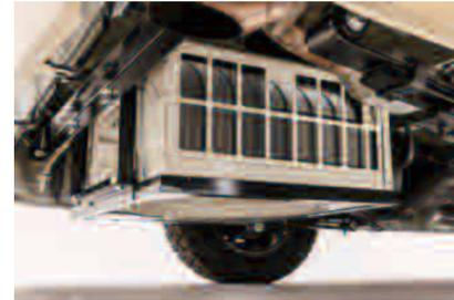
冷却効果の高い家庭用エアコンが取り付け可能で、室外機はボディ下に設置されます。
