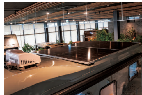
出力 1155W のソーラーパネルが設置されているので、電源のバックアップも安心です。
