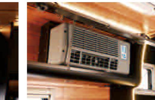
吊り下げ棚の中にDC12V クーラーを設置しました。電気の変換口も少なく、効率よく室内を冷やしてくれます。冬場など、使わない時は棚の扉を閉じて、スマートに収納しておくことが可能です。
