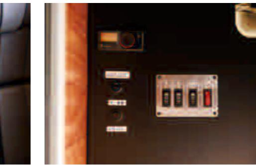
停泊時に車両の水平を保ち、ボディの揺れを防ぐためにスタビライザージャッキが装備されています。車内のスイッチを操作するだけ、ボディ下から電動ジャッキが出てきて、車両を安定させます。
