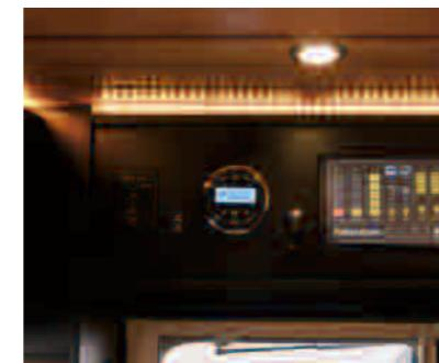
タッチセンサータイプ大型液晶ディスプレイを採用したオリジナルのコントロールパネルが装備されています。ライドのオンオフや設備のコントロール、ウォータータンクの状態を確認できます。
