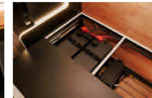
電気容量 600Ah のリチウムイオンバッテリーを搭載。走行充電とソーラーパネルを使って充電しているので、長期間の旅行でも安心してご利用いただけます。
