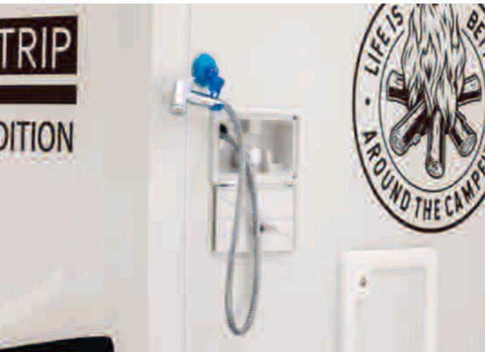
ボディの右側後方にアウトドアシャワーが収納されています。車内のボイラー設備を使うことで、アウトドア温水シャワーとしても利用できます。泥汚れを流す時などにも重宝します。
