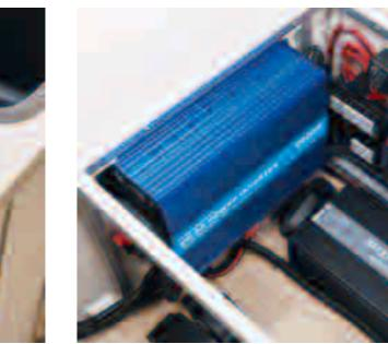
ディープサイクルバッテリー 200Ah と出力 2000W のインバーターを搭載。効率よくサバッテリーを充電する走行充電システム C-TEK が採用され、移動中にサバッテリーをしっかりと充電します。
