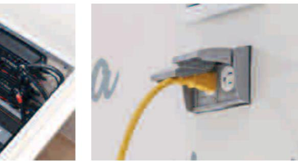
キャンピングカーの外側で AC100V を使えるように、外部出力 100V コンセントが取り付けられました。搭載されているインバーターの出力も大きいので、電子調理器を外で利用することも可能です。
